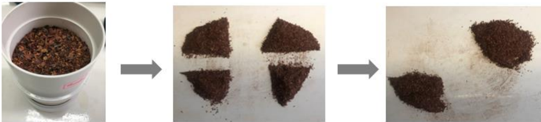
Figura 5. Processo de peneiramento e quarteamento da biomassa da casca de pinhão.
