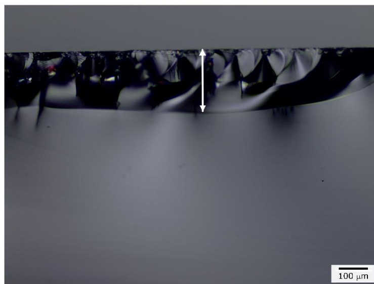
Figura 23 - MO da vista da trinca gerada após a ruptura da amostra de BS2, com taxa de deslocamento de 500 \mu\text{m}/\text{min} , com indentação Vickers.
