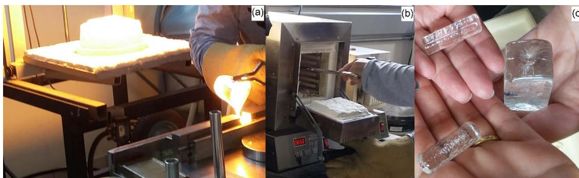
Figura 15 - a) Fusão do vidro BS2, b) Alívio de tensão e c) obtenção dos vidros BS2 em diferentes formatos.
