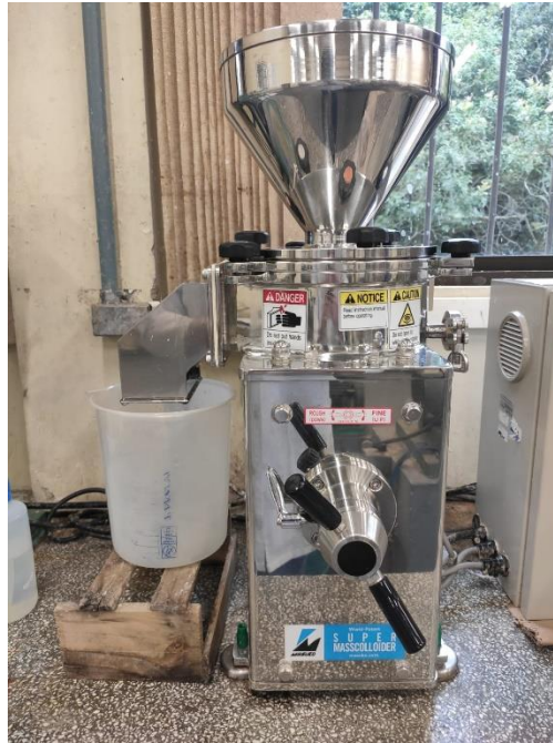
Figura 4.2 - Moinho utilizado para a obtenção da nanocelulose.
