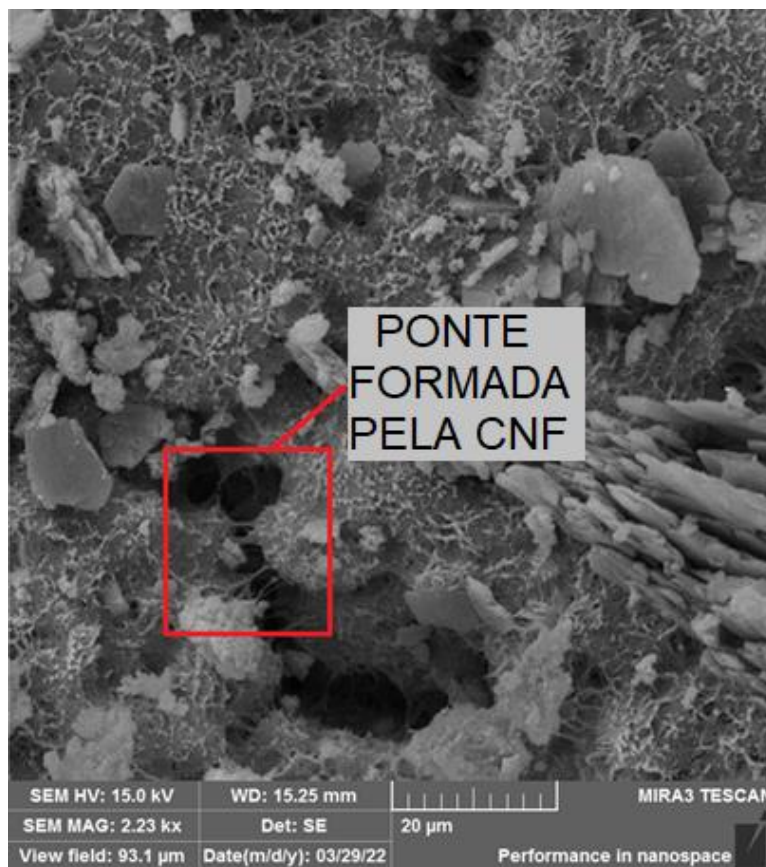
Figura 6.14 - Imagem de microscopia de pasta de cimento demonstrando a formação de pontes entre fissuras pelas fibras de CNF
