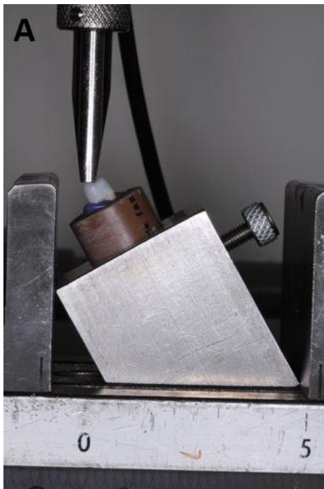
Figura 18 – A – Teste de resistência à fratura; B - Plano inclinado de 30° em relação ao plano do solo, com uma cavidade cilíndrica na porção central para adaptação do tubo de PVC. O dispositivo metálico formou um ângulo de 150° entre o cone de aço do mordente superior da máquina de ensaio universal e o longo eixo das raízes, simulando o componente de forças que atuam sobre os dentes posteriores.
