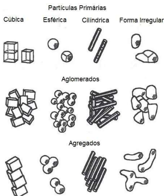
Figura 2 - Partículas, aglomerados e agregados
