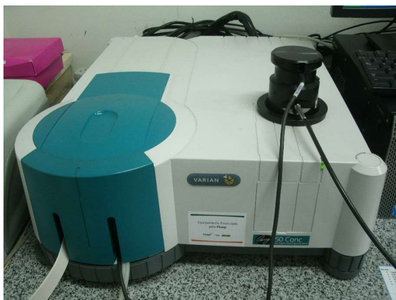
Figura 28 - Espectrofotômetro UV-Vis com acessório barrelino - UEPG
