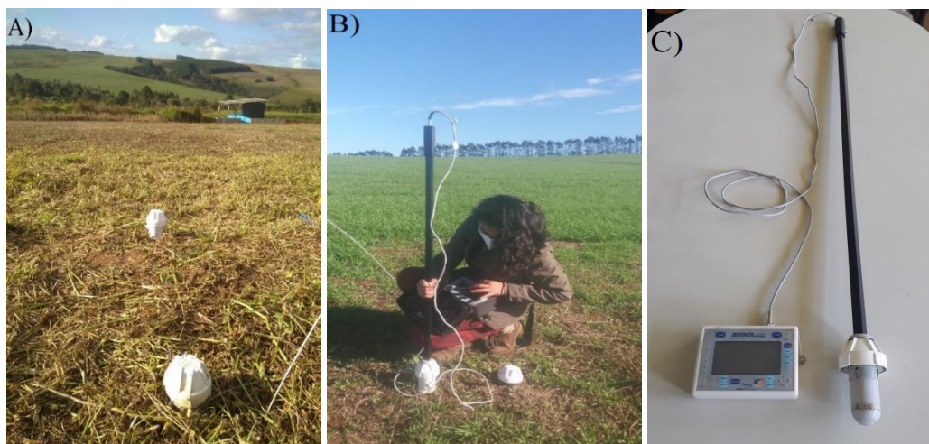
Figura 3 – A) Tubos de acesso; B) Monitoramento da água no solo em tubos de acesso; C) Aparelho Diviner 2000. Fazenda Escola “Capão da Onça” pertencente a Universidade Estadual de Ponta Grossa-UEPG. Ano 2022.
