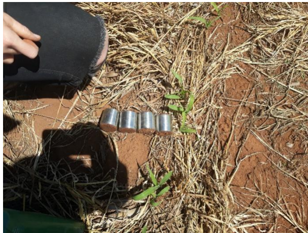
Figura 5 -Coleta indeformada do solo com anéis volumétricos, 2019.
