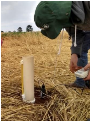
Figura 3 -Sensor de umidade do tipo TDR Moisture Meter HH2 ThetaProbe®.
