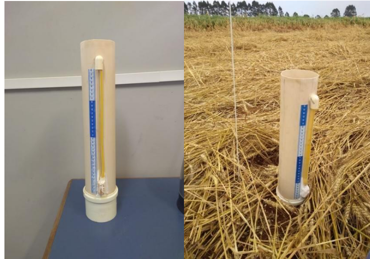
Figura 2 - Permeâmetro de Philip Dunne modificado confeccionado no Laboratório de Irrigação e Hidrologia Agrícola da UEPG.
