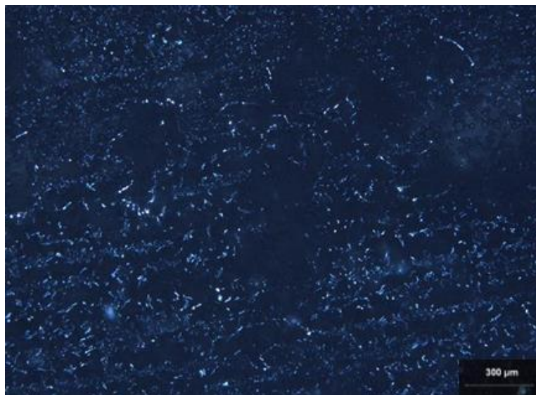
Figura 16. Visualização da fase líquido-cristalina através de microscopia de luz polarizada em aumento de 50x da formulação 8 (T10:O10:A80, p/p) associada com hidroxietilcelulose HEC 0,5% (p/p) no 1º dia.
