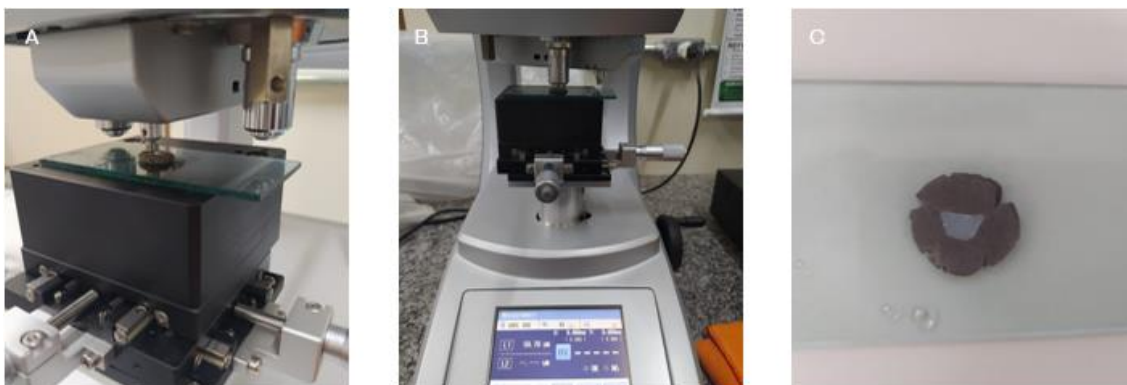
Figura 6: Análise de dureza Vickers (VHN). Em A, amostra com o indentedor em posição; em B, visão geral do Microdurômetro com o microscópio em posição; em C, a amostra de resina posicionada na placa de vidro para análise
