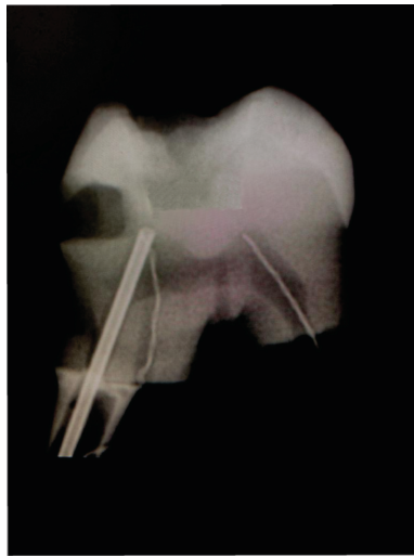
Figura 6 - Imagem de radiográfica para verificar a posição dos termopares e a espessura da dentina.
