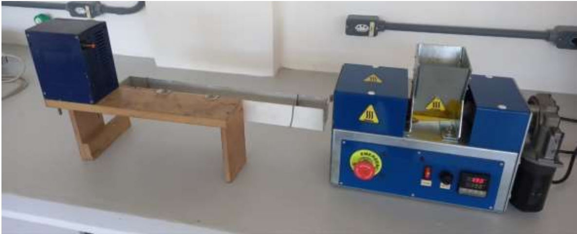
Figura 27 – Sistema de processamento dos nanocompósitos: Miniextrusora Filmaq3d STD e Dispositivo Enrolador de Filamentos.
