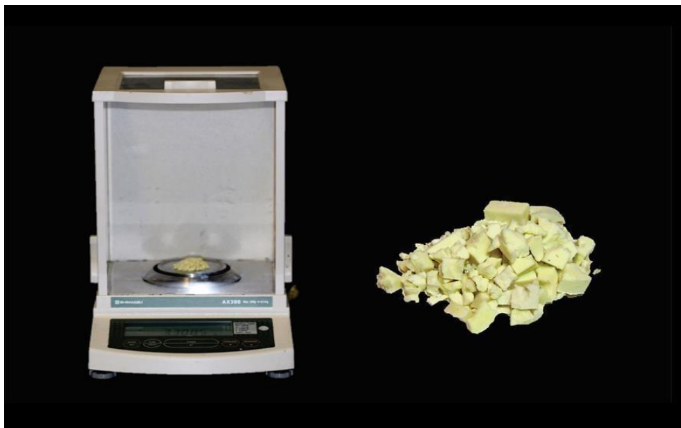
Figura 8 - Partículas pesadas em balança analítica de 0,001 g.
