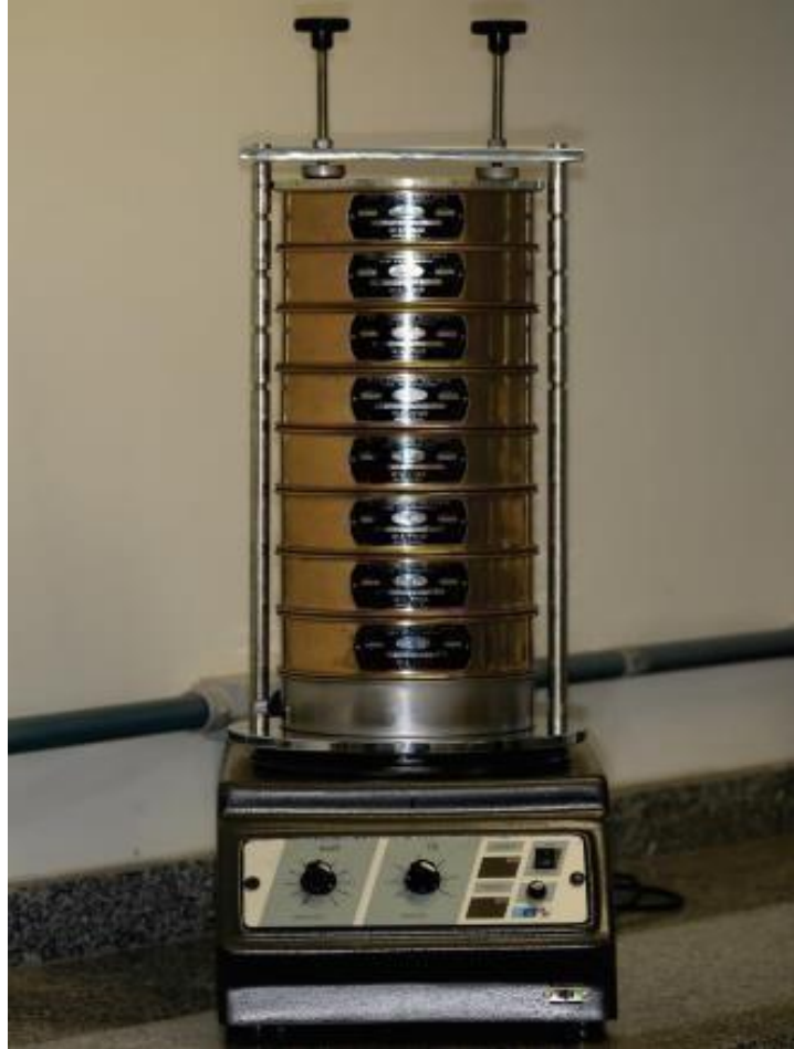
Figura 7 - Partículas sendo peneiradas em tamises da maior para a menor, com o auxílio de um vibrador.
