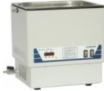
Figura 18 - Banho térmico com circulação do líquido através de bomba de demanda, com vazão de 10L/min. Sistema de aquecimento através de resistência tubular de 1000 W e termopar PT 100.
