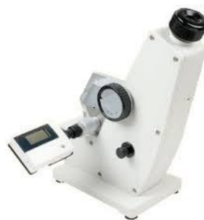
Figura 17 - Refratômetro de ABBE, escala de refração 1,3000-1,7200(\pm 0,0002)n_D (Mod.2 WAJ).
