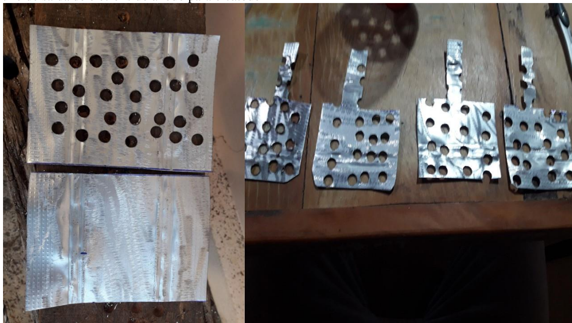
Figura 17 – Fotos das chapas metálicas cortadas e perfuradas para dar suporte e contato entre as biomédias e criar o fluxo de saída de elétrons do ânodo para o cátodo
