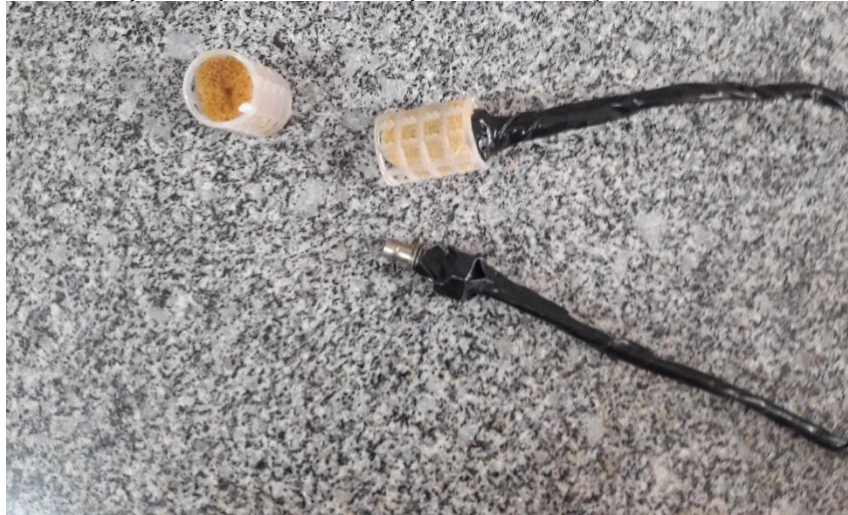
Figura 21 – Sensores Termopar do tipo k modificados para evitar interações com o interior do reator
