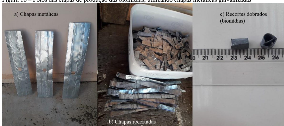
Figura 16 – Fotos das etapas de produção das biomédias, utilizando chapas metálicas galvanizadas
