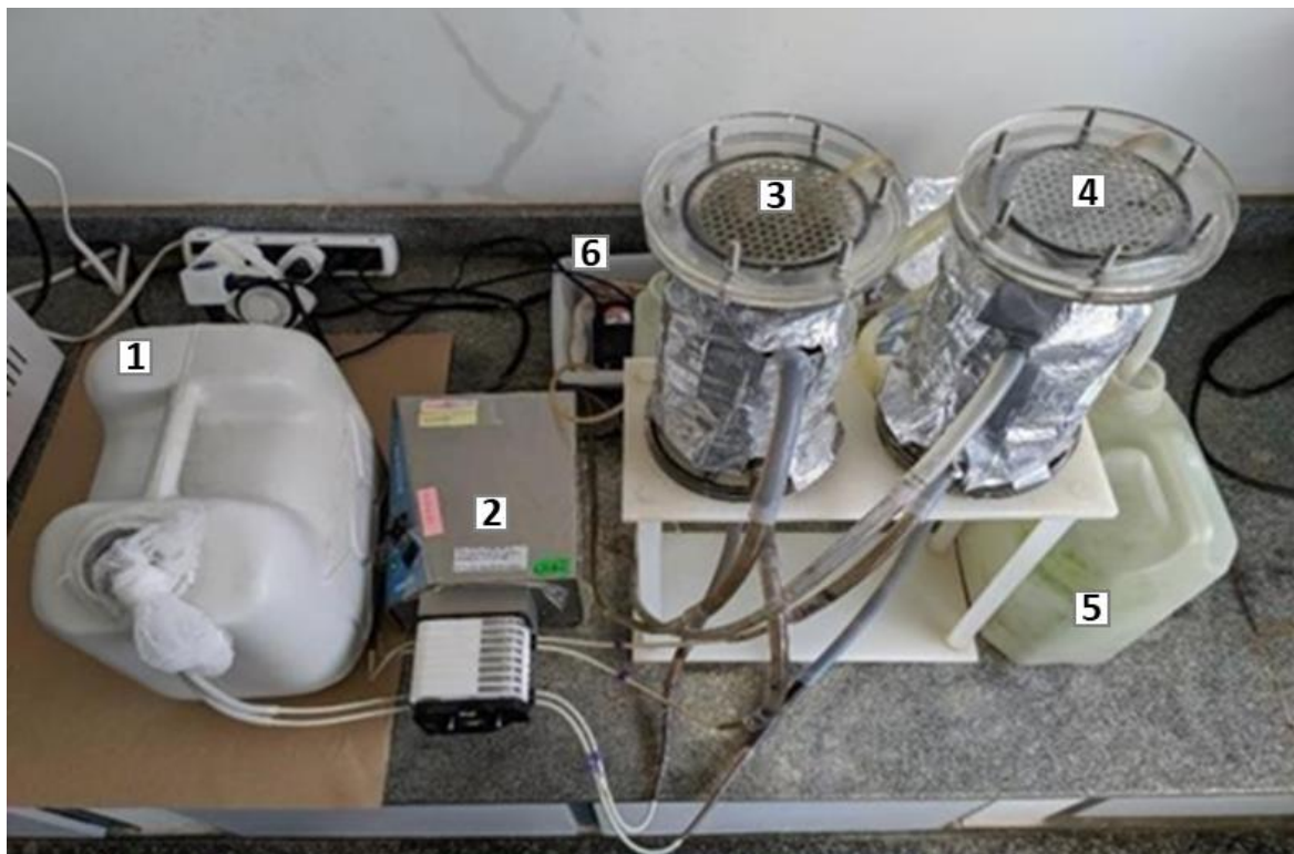
Figura 4 - Foto do aparato experimental dos reatores operados em escala de bancada com leito fixo ordenado e empacotado
