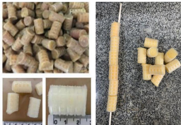
Figura 2 - Mini Biobobs ® utilizados como material suporte para biomassa.
