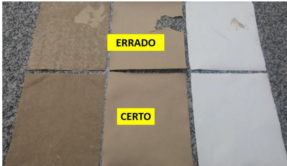
Figura 14 — Exemplos de delaminação.
