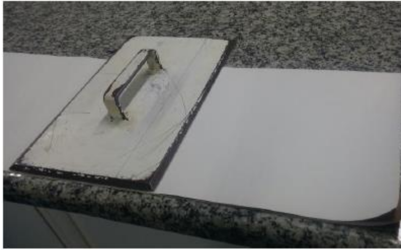
Figura 11 — Corte da amostra no formato 30x30cm.
