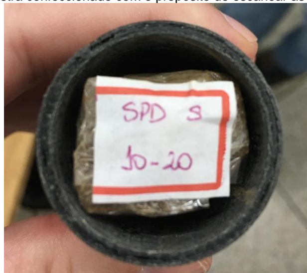
Figura 2.10 – Porta-amostra confeccionado com o propósito de escanear as amostras de solo.
