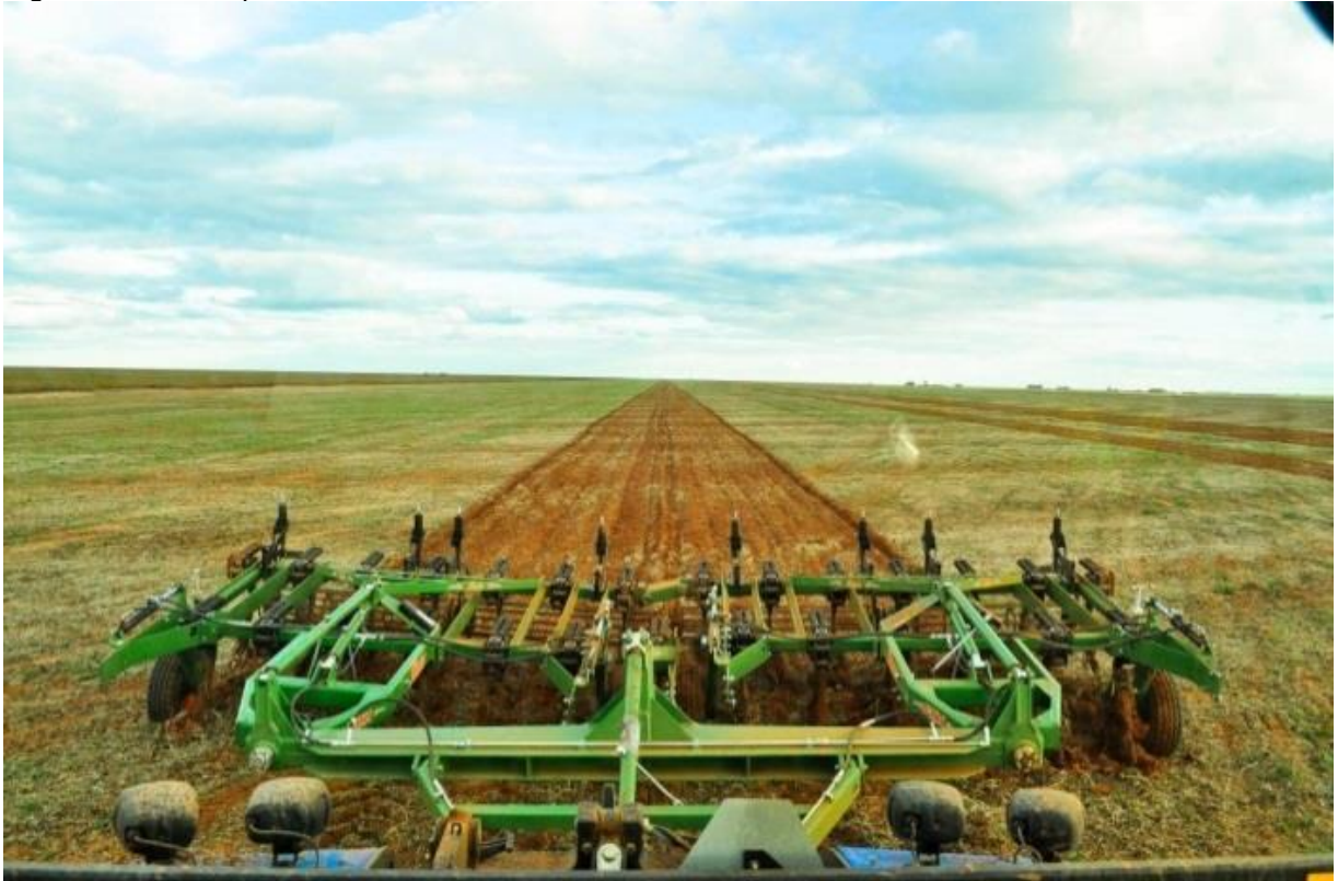
Figura 2.5 – Exemplo de subsolador com sistema de desarme automático de hastes.
