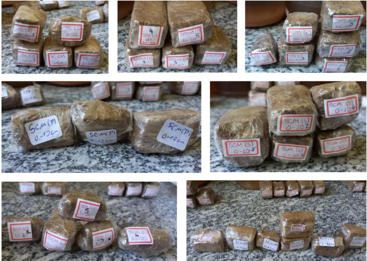
Figura 2.9 – Confeção, embalagem e etiquetagem das amostras para posterior análise microtomográfica.
