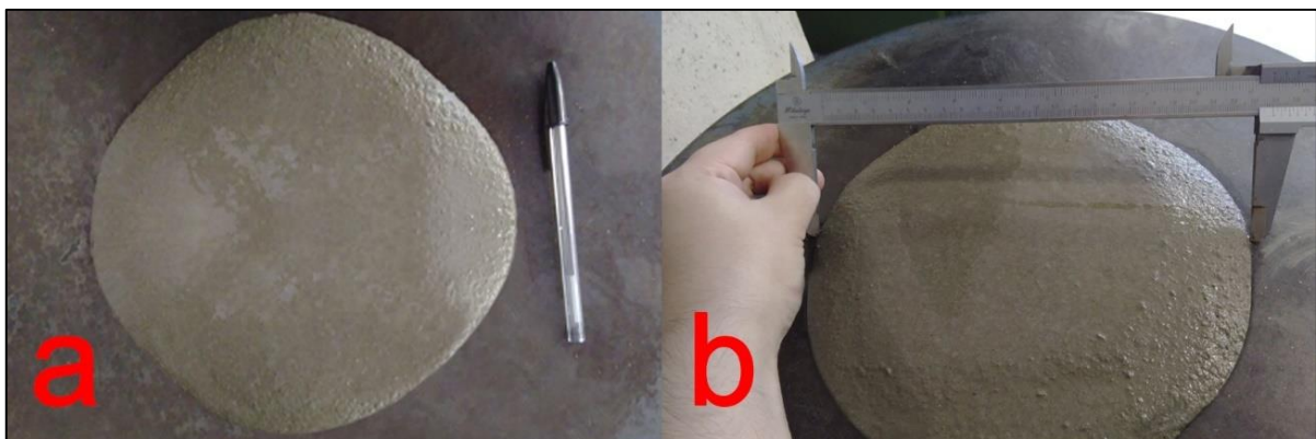
Figura 11 - Índice de consistência: (a) espalhamento e (b) aferição de diâmetro.
