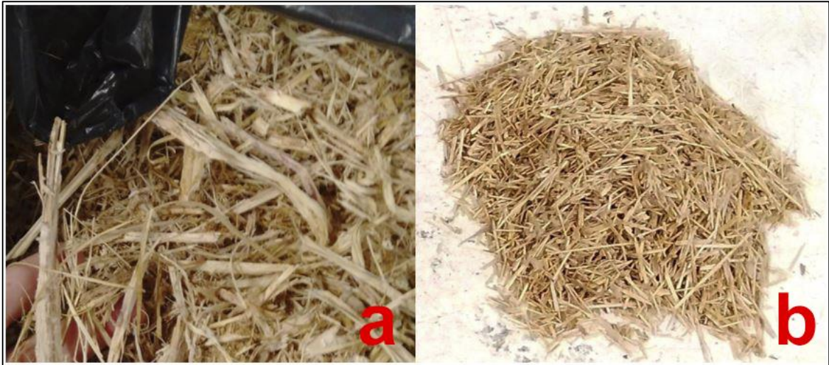
Figura 7 - Fibras cortadas: (a) fibras grandes e irregulares; (b) fibras cortadas e regulares.
