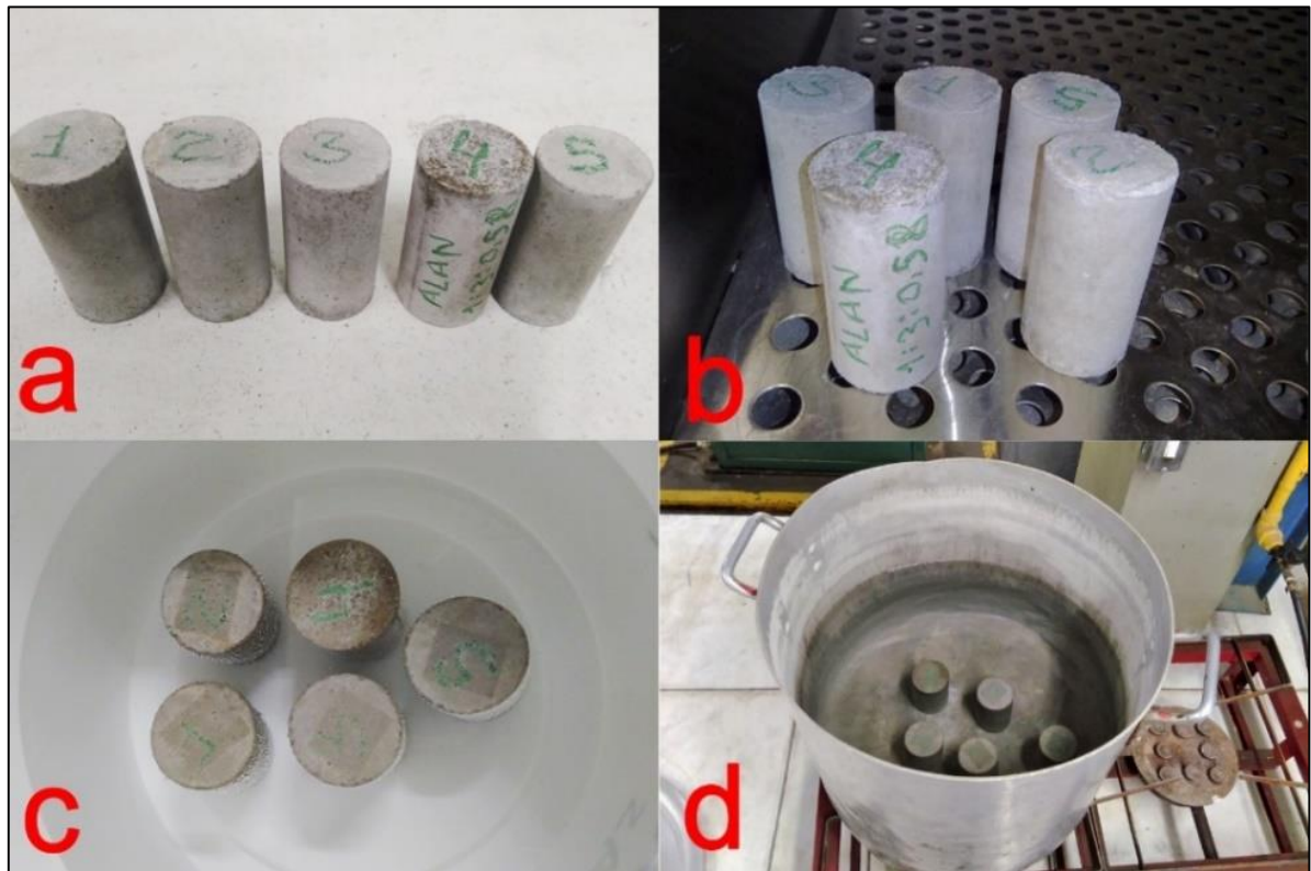
Figura 13 - Etapas do ensaio de absorção: (a) corpos de prova naturais; (b) após 72h em estufa; (c) após 72h submerso; (d) após 5h de fervura.
