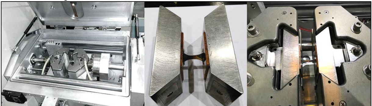
Figura 38. Câmara do simulador termomecânico Gleeble 3S50 , mostrando o posicionamento da amostra entre as garras.
