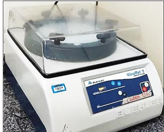
Figura 48. Equipamento de polimento vibratório Buehler Vibromet 2 .
