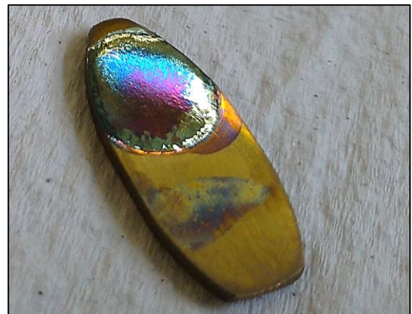
Figura 54. Fotografia de amostra após ataque com chama.
