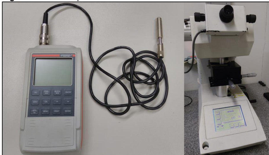
Figura 35. Ferritoscópio e microdurômetro utilizados.
