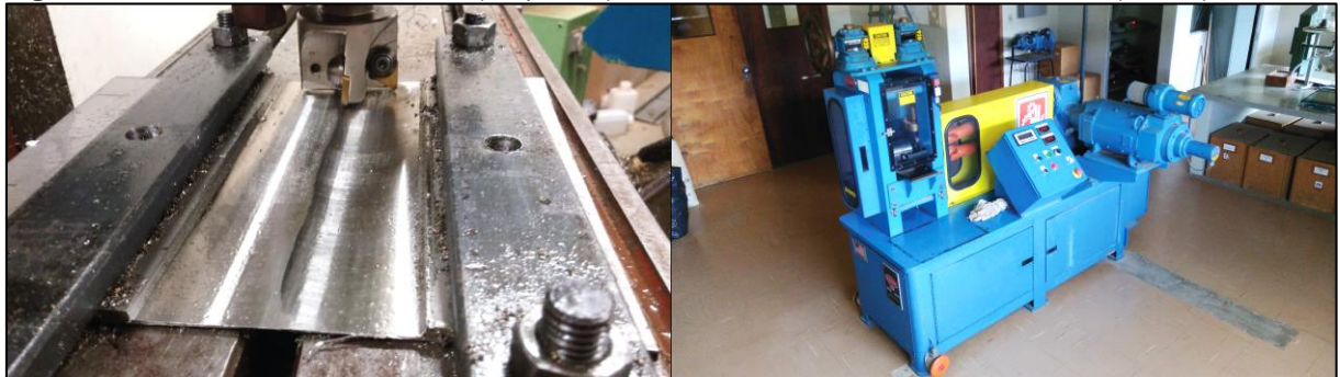
Figura 30. Processo de fresamento (esquerda) e o laminador de laboratório utilizado (direita).
