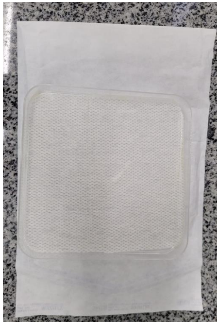
Figura 4 - Curativo de alginato-babosa após secagem em estufa no molde de poliestileno. Fonte: Os autores, 2023.
