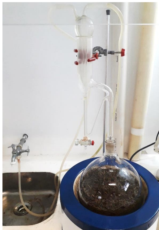
Figura 36 – extração de óleo essencial em aparelho de Clevenger
