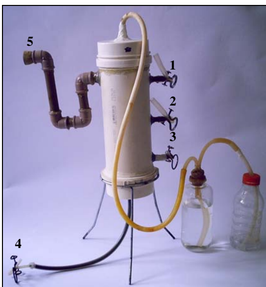
Figura 8 – Foto do reator com os pontos de alimentação e retirada de amostra
