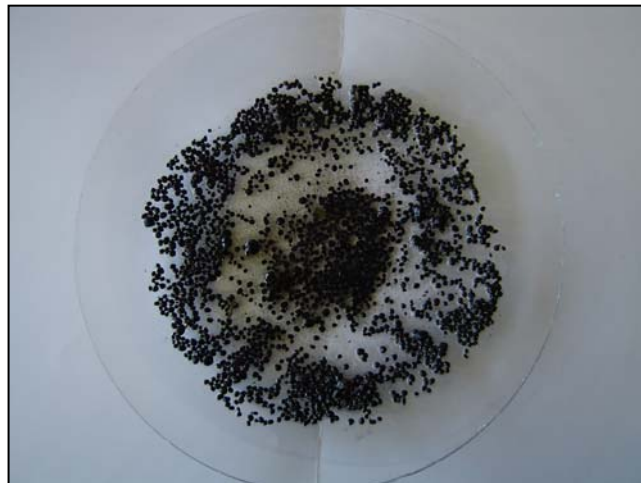
Figura 7 - Lodo do reator metanogênico da cervejaria FEMSA, utilizado como inóculo neste experimento
