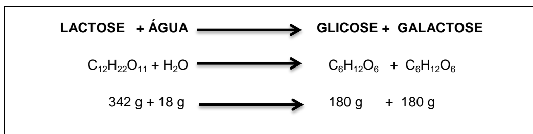
Figura 11 – Reação de hidrólise da lactose: método enzimático
