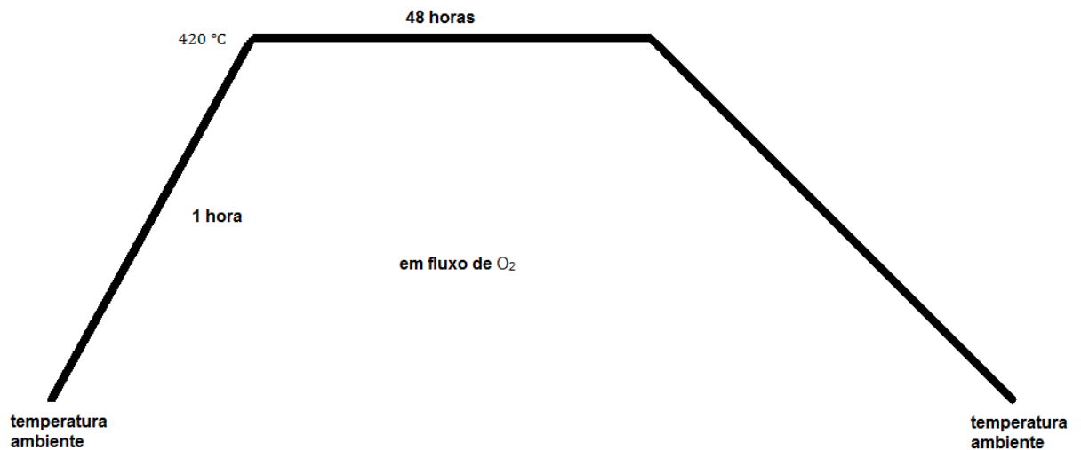
Figura 12 - Rampa de temperatura utilizada no processo de oxigenação.
