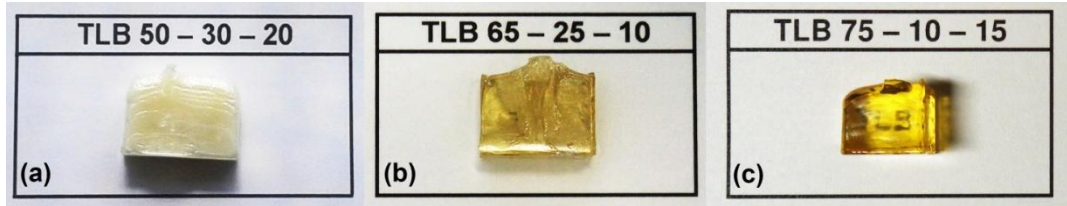
Figura 4.2 – (a) Amostra totalmente cristalizada. (b) Amostra parcialmente cristalizada. (c) Amostra vítrea.
