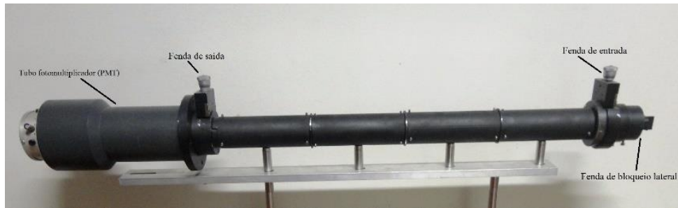
Figura 2.13 - Fotografia do primeiro tubo detector idealizado para o sistema (fonte o autor).
