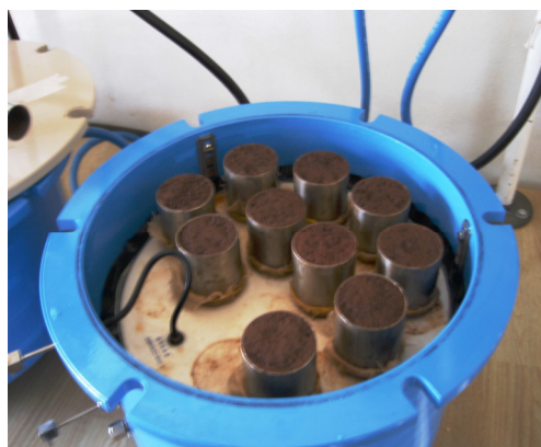
FIGURA 2.2.4: Amostras na câmara de Richards.
