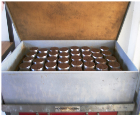
FIGURA: 2.2.3: Amostras na mesa de tensão.
