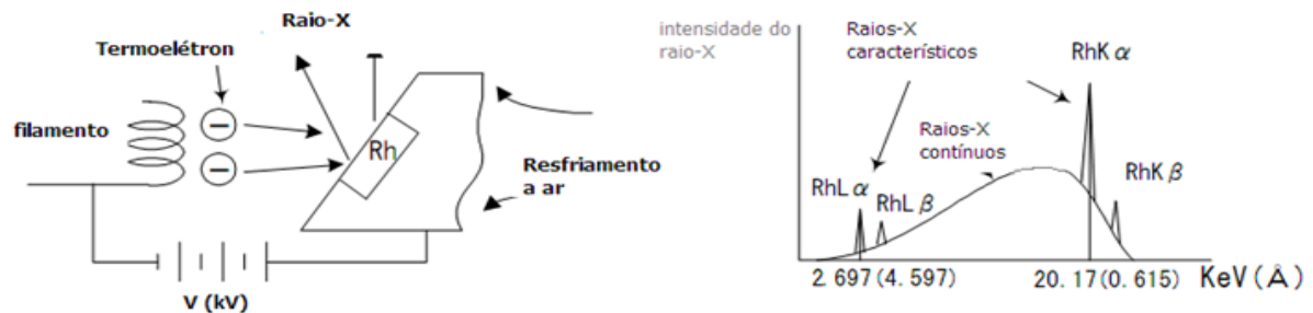
FIGURA 7 - Configuração do tubo de raios X e seus respectivos espectros característicos e contínuos.
