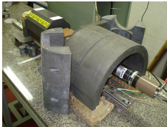
FIGURA 10 - Mesa de medidas contendo o castelo de chumbo com as fontes radioativas e a blindagem de Pb sobre o detector.
