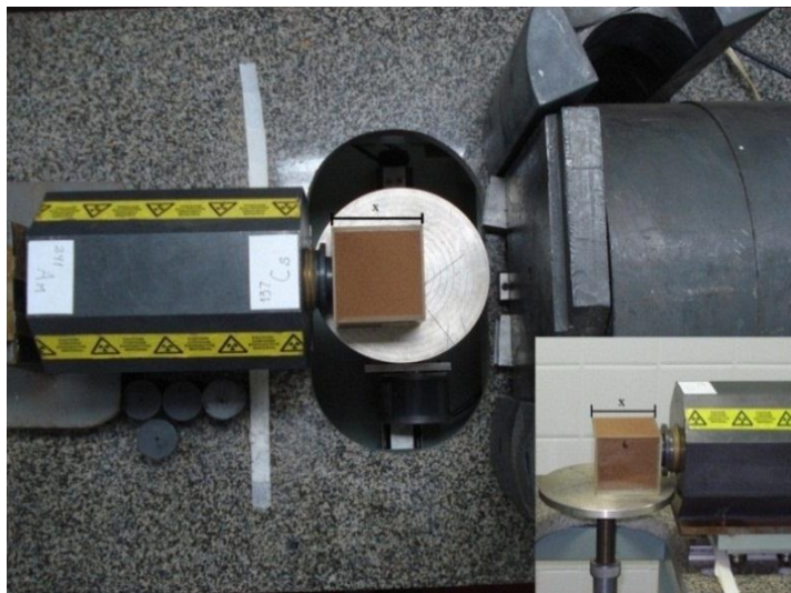
FIGURA 15 - Arranjo experimental: Castelo de chumbo contendo as fontes radioativas, caixa de acrílico com amostra de espessura x , e cilindro de chumbo contendo o detector. O canto inferior da figura mostra uma visão panorâmica do recipiente que contém a amostra.
