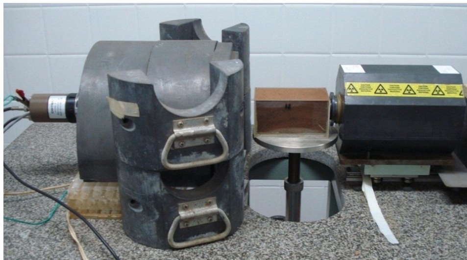
FIGURA 16 - Arranjo experimental. Da esquerda para direita: detector blindado com chumbo, recipiente contendo a amostra, castelo de chumbo com fonte radioativa.
