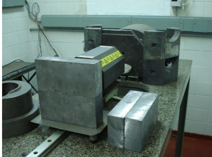
FIGURA 9 - Mesa de medidas. Sobre o trilho encontra-se o castelo de chumbo contendo as fontes radioativas. Os blocos de Pb são utilizados para a blindagem do castelo e do detector.
