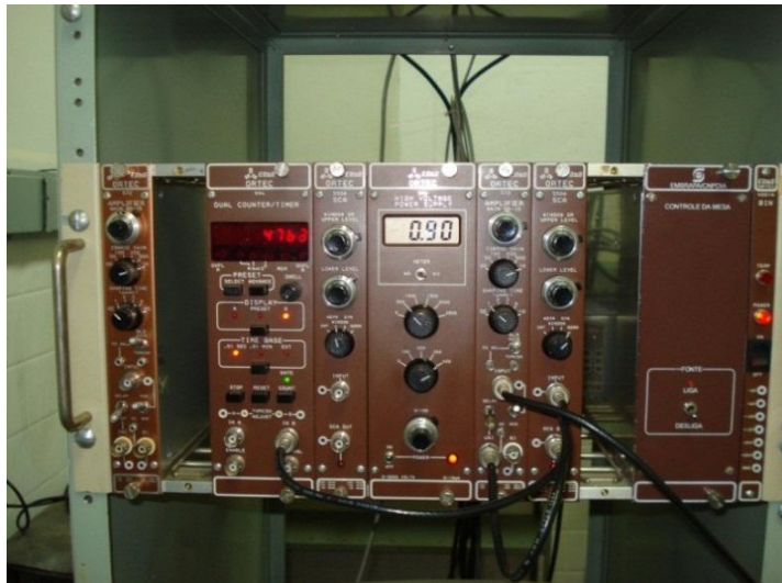
FIGURA 13 - Componentes que constituem a eletrônica do espectrômetro gama. Da esquerda para a direita: amplificador, temporizador/contador, fonte de alta tensão, e analisador monocanal. Todos esses módulos se encontram acoplados a um bastidor bin.
