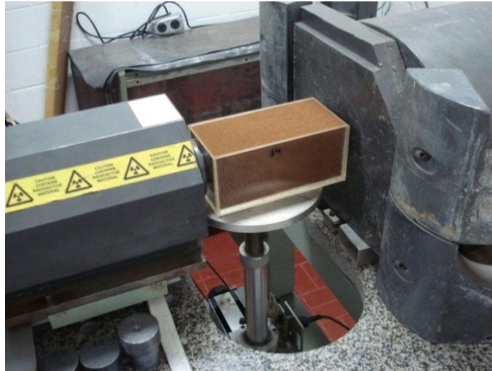
FIGURA 11 - Arranjo contendo fonte, amostra e detector blindado. Abaixo da amostra é possível observar o equipamento que permite a movimentação vertical da amostra.
