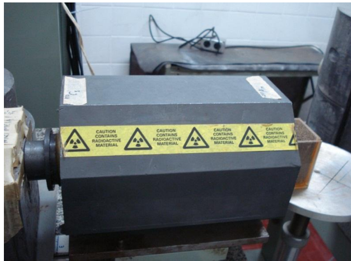
FIGURA 8 - Castelo de chumbo contendo as fontes radioativas de ^{137}\text{Cs} e ^{241}\text{Am} , localizadas nas suas extremidades.
