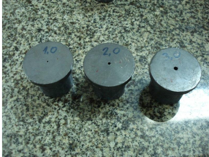
FIGURA 12 - Colimadores circulares de diferentes diâmetros, utilizados na colimação da saída da fonte.
